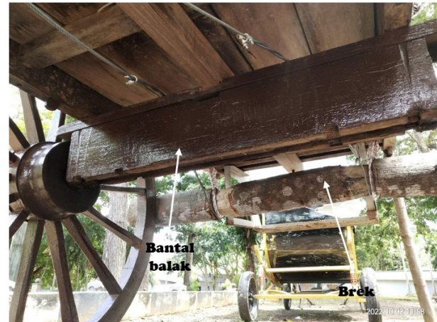
GAMBAR 10. Bantal balak dan brek Sumber: Kajian lapangan
