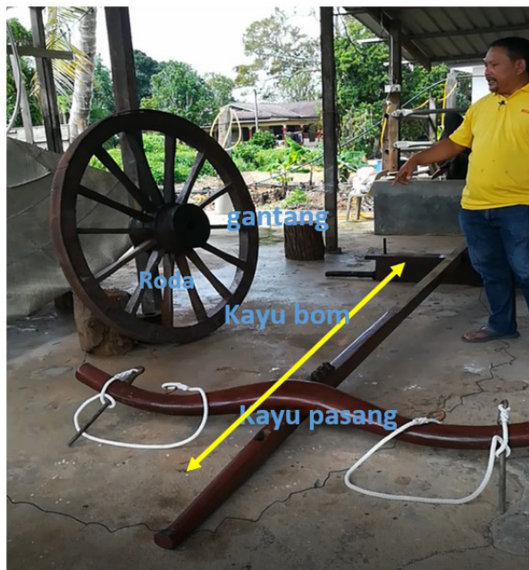
GAMBAR 3. Roda, kayu bom, gantang, kayu pasang Sumber: Kajian Lapangan
