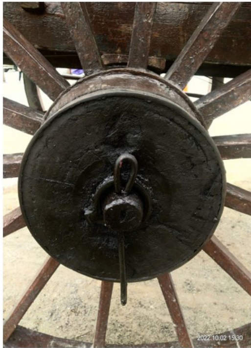
GAMBAR 2. Roda dan Gantang Kereta lembu Sumber: Kajian Lapangan
