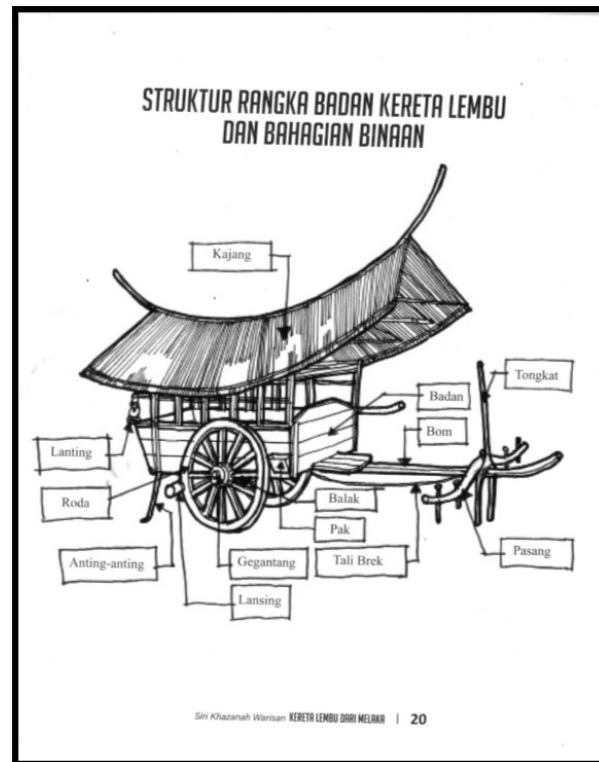
RAJAH 1. Struktur Binaan Kereta Lembu
